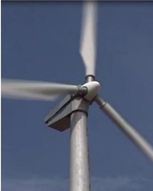
L'aerogeneratore NW 250 kW rappresenta il modello ideato per i mercati internazionali ove non esistono particolari limiti di incentivazione. Il rotore maggiorato da 31 metri di diametro con tecnologia a stallo passivo, già visto per il modello "extended" da 200 kW, è accoppiato tramite moltiplicatore di giri multistadio a un generatore asincrono a doppia velocità, capace di 250kW elettrici nominali, che assicura elevato rendimento di conversione a tutti i regimi di rotazione.
